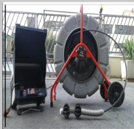
Telecamera per visionare tubazioni con diametro da \varnothing 120 a \varnothing 200
