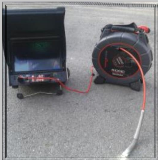
Telecamera per visionare tubazioni con diametro da \varnothing 50 a \varnothing 80 con sensore
