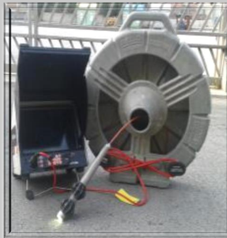
Telecamera per visionare tubazioni con diametro da \varnothing 80 a \varnothing 150 con sensore
